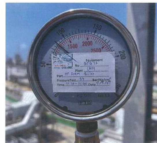
ภาพถ่ายแสดงขณะทำการทดสอบความดันในการตรวจสอบหม้อน้ำ
